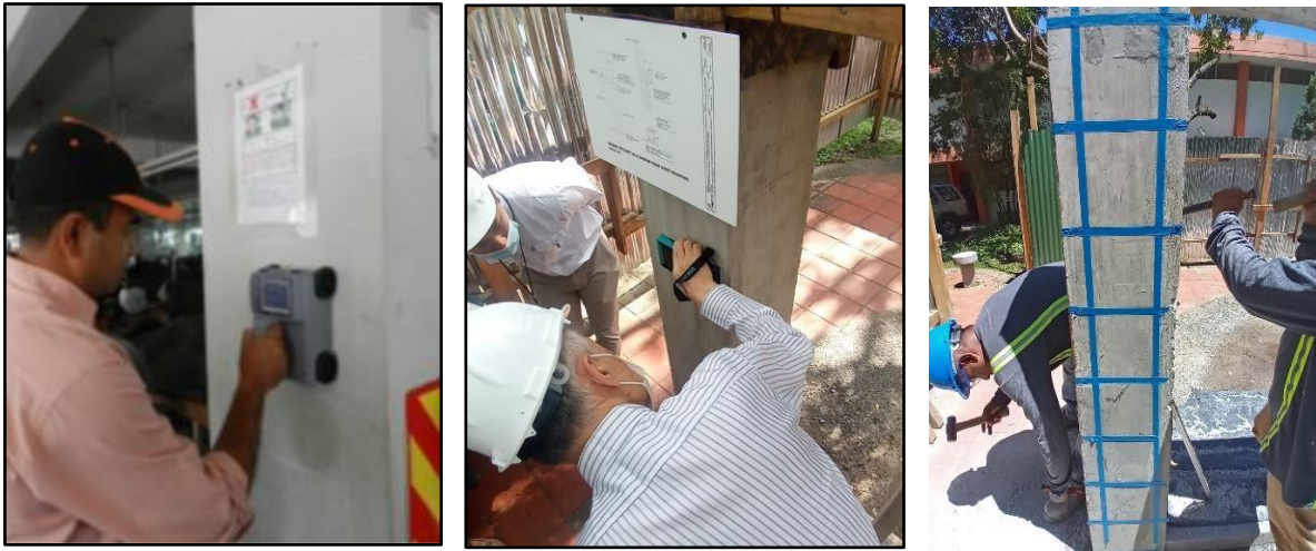
Figura 2.2-2 Confirmación y marcado de ubicación de varillas de refuerzo con escáner detector de varillas
