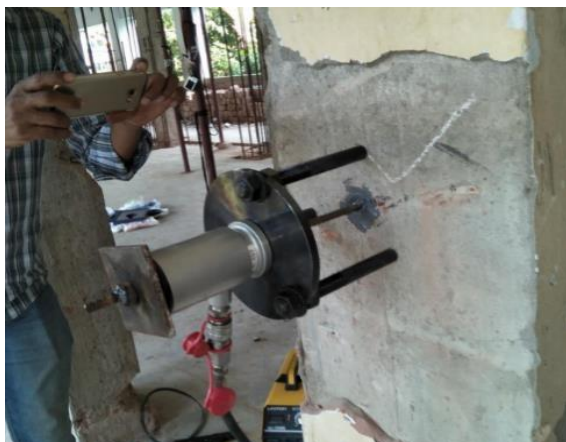
Figura 5.9-1 Prueba “Pull Out” para anclajes realizada en campo.
