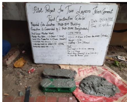
Figura 3.7-6 Preparación de la muestra de prueba para el ensayo de resistencia a la compresión de un cubo (mortero).
