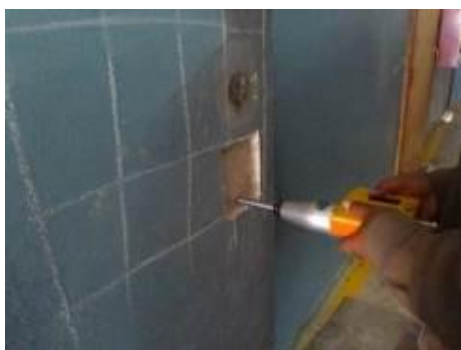
(c) Prueba con Martillo de Rebote
