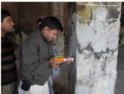
Figura 4.4-7 Prueba con martillo Schmidt
