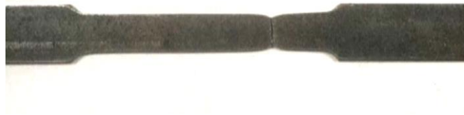
Figura S1.2-18 Muestra de tubo de acero estructural HSS 2\frac{1}{2}" \times 2\frac{1}{2}" \times 1/8" . utilizado en espécimen SP-1
