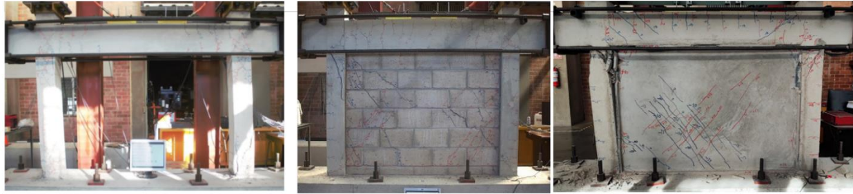
Espécimen SP-01 Espécimen SP-03 Espécimen SP-09 Marco de concreto reforzado de Marco con pared de relleno de Laminación con ferrocemento referencia bloque de concreto
