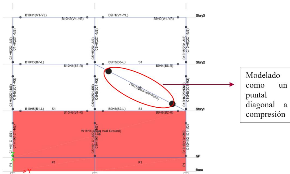
Figura C3.1-6 Modelado de pared de laminación con ferrocemento (segundo nivel)
