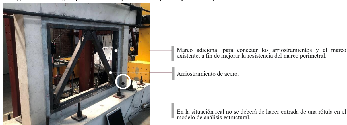
Figura 4.2-14 Ejemplo de instalación de marco de arriostramiento metálico
