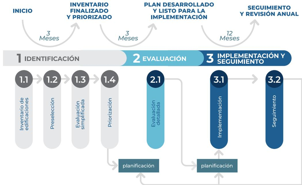
Figura 8: Fases del proceso de planificación del reforzamiento sísmico de edificaciones. Fuente: Elaboración propia
