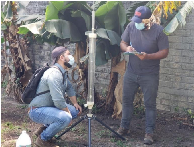
Figura 3. Permeámetro de Guelph utilizado en el campo (Fotografía propia)
