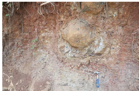
Fig. 52d Meteorización laterítica del flujo de lava de andesítica muestra junta en bloques: la meteorización produce lateritas con bloques redondeados de andesita., Loma Espino NNO de Nejapa (+13.8684483, -89.2459043).
