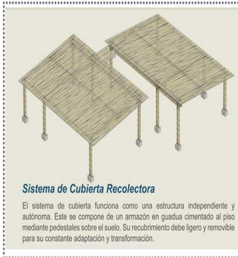
Figura 12. Sistema de cubierta recolectora
