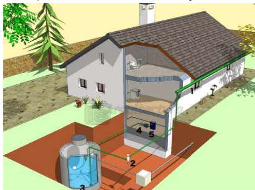
Figura 18. Esquema de recolección de agua lluvia
